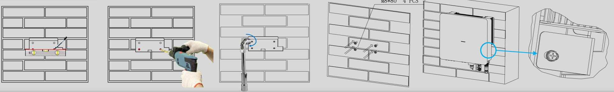
连接接地保护线 (PE)
