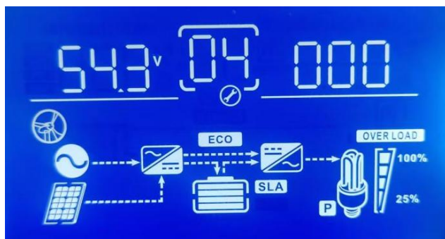
铅蓄电池浮充电压设置显示示意图
