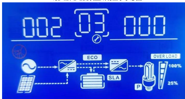
电池类型设置显示示意图
