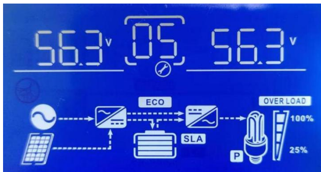
铅蓄电池均充电压设置成功示意图
