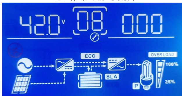
铅蓄电池放电截至电压设置显示示意图
